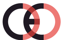
Marcatura CE contraffatta (troppo vicino)
